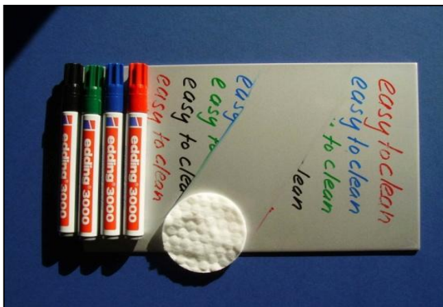
Abb. 4: Beschmutzte nanoversiegelte Aluminiumoberflächen lassen sich problemlos reinigen.
